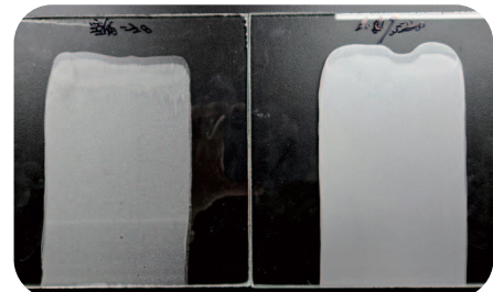
案例2-9：水性增稠剂YRFC-RG03W对水性银粉漆的定向效果
